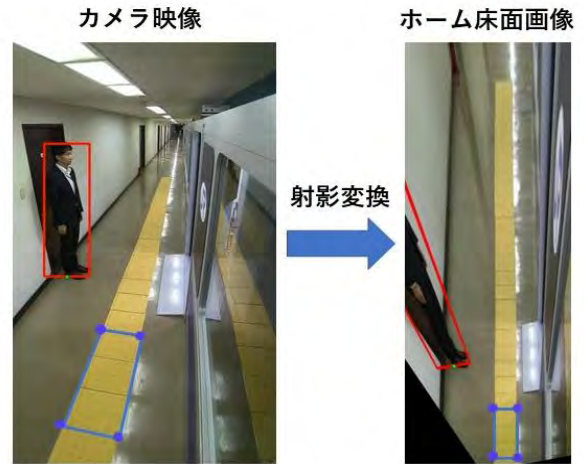
図5 車両側面カメラ映像に対する射影変換
