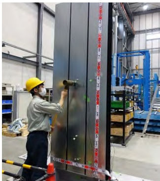
図 8 衝撃加振試験の実施状況 (3 ユニット連結時)
