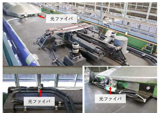
図 10 離線アーク光の測定
