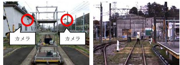
図 5 使用したステレオカメラと取得した画像 Fig. 5. Stereo camera and acquired images
