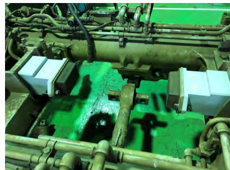
図 4 クラッシュブル機能を停止した左右動ストッパ
