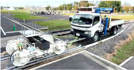
図 4 センサー類を搭載した計測編成 (重り 0 枚の状態)
