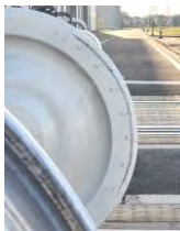
図 6 乗り上がりにもなう脱線防止ガードとの接触痕
