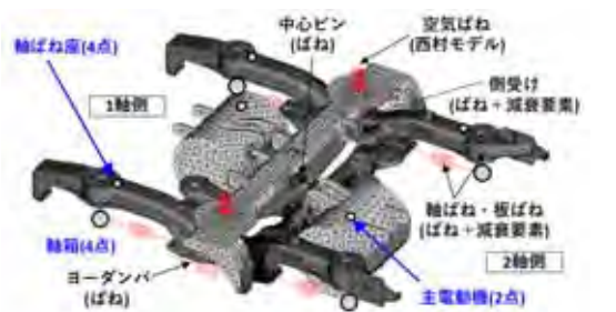
Fig.3 FEM 解析モデルと振動加速度測定点 2 - 台車 B
