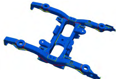
青 : 母材, 黄 : As-weld, 赤 : グライнда仕上げ
