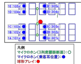
図 3 E956 形 4 号車前位側客室の騒音測定点
