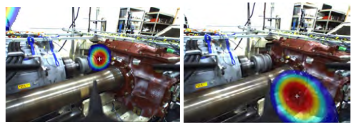
(a)主電動機振動と相関が高い (b)歯車振動と相関が高い (3150Hz 付近) (1100Hz 付近)
