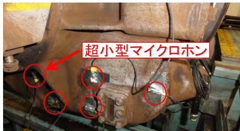
図3 超小型マイクロホンの歯車箱貼付状況
