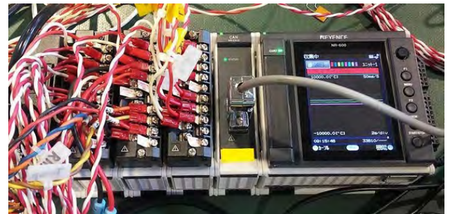
図 7 CAN 通信に対応した計測システム
