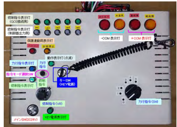
図 3 可搬式エンジン簡易制御卓
