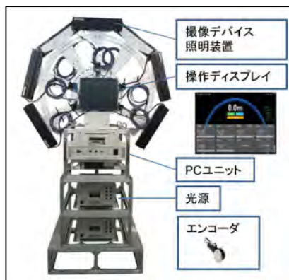
図-2.2 トンネル計測システム(TM-270)機材全景
