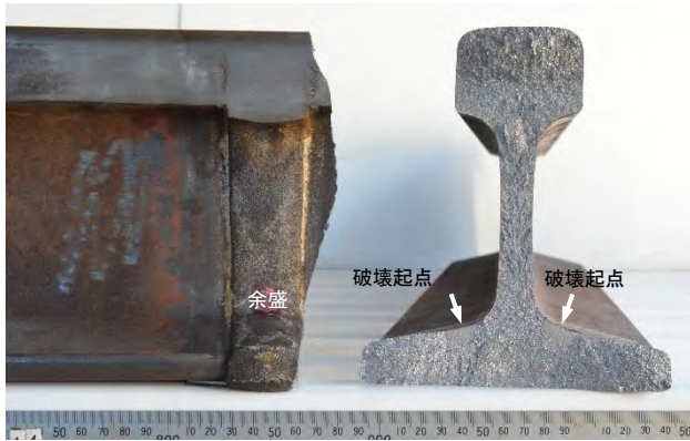
図 5 曲げ疲労試験で破断した試験体の外観 (D-2)
