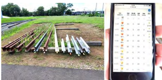
図 5 屋外且つ直射日光環境での試験片の温度測定
