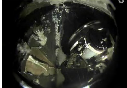
図 10 フサギ板下端部の着雪の様子(2022/2/22)
