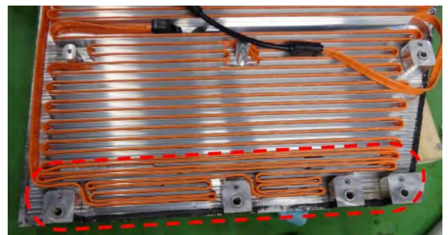
図2 出力増強後のヒータ敷設状況
