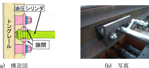
図 7 トングレールと転換ユニットの接続部 (3 号機)
