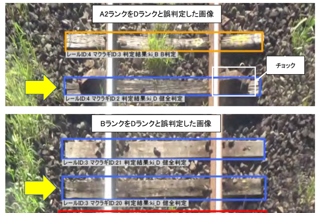
図 7 不良まくらぎを良好なまくらぎと判定した画像
