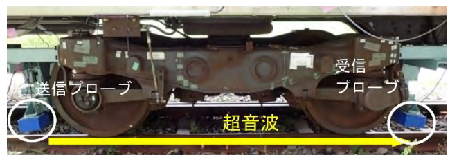
図 1 台車に設置した超音波送受信プローブ
