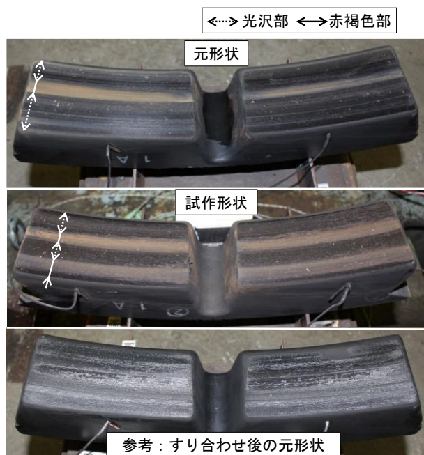
図 10 200ml/min 連続散水試験後の制輪子摩擦面
