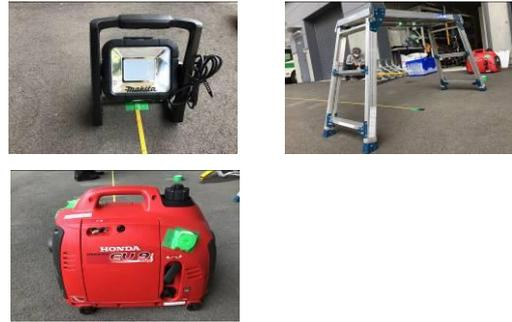
図5 BLE タグ取付工具
