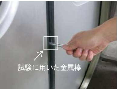
図5 挟み込み検知感度試験の状況
