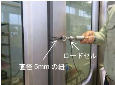
図 7 引きずり検知荷重試験の状況
