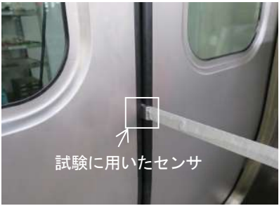
図4 挟み込み力試験状況
