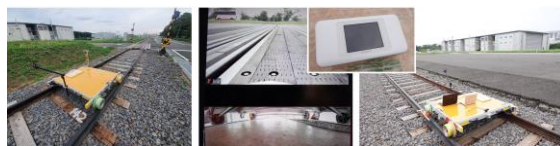
図7 試験台車2（円錐車輪，Wimax2 付加）
