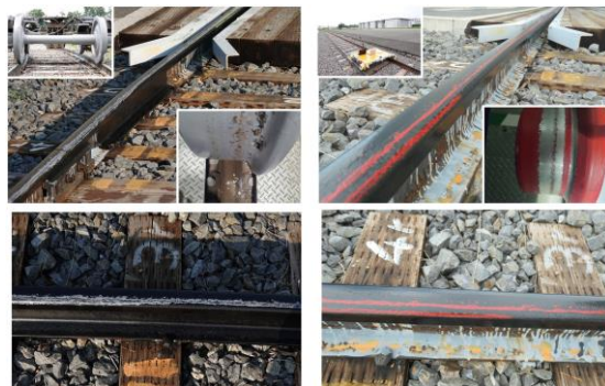
図8 左図は試験台車1（円弧車輪）、右図は試験台車2（円錐車輪）が下り方向に、直線から定常曲線に入った可視化したレール上接触痕、右図は急激にフランジ接触している。
