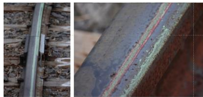
図8 左図は試験台車1（円弧車輪）、右図は試験台車2（円錐車輪）が下り方向に、直線から定常曲線に入った可視化したレール上接触痕、右図は急激にフランジ接触している。
