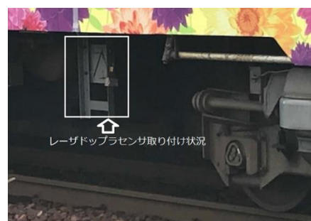
図 4 レーザドップラセンサの取り付け状況
