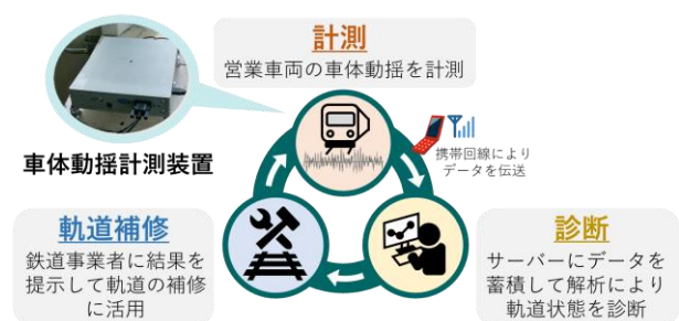
図1 軌道状態診断システム
