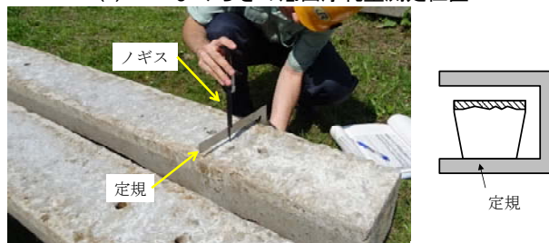
(b) PC まくらぎの底面摩耗量の測定状況
