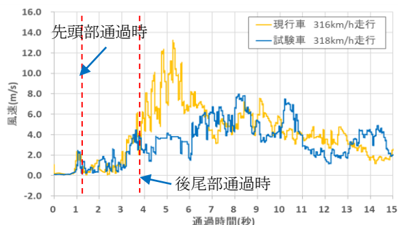
図8 列車風発生時系列図 現行車・試験車比較
