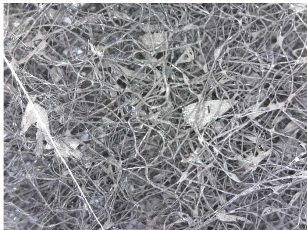
図8 捕集フィルタにより確認された塵埃
