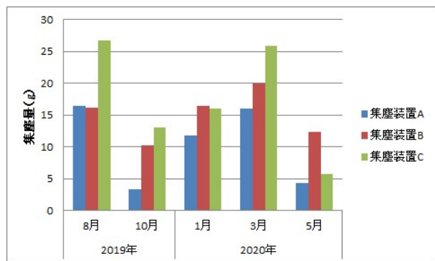
図6 集塵装置による回収した塵埃量
