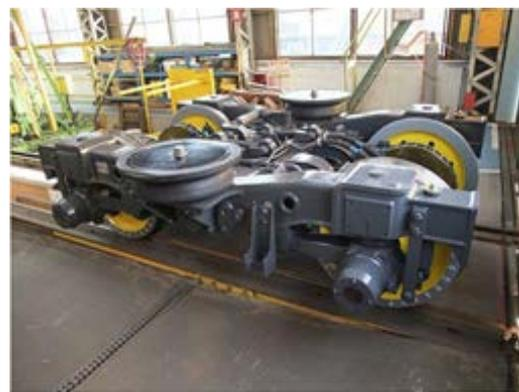
図1 輪重減少抑制台車の外観
