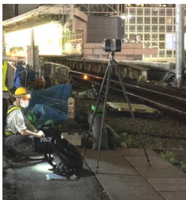
図5 据置型三次元スキャナ撮影風景
