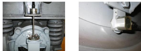
写真3 輪重・横圧測定センサの概要
