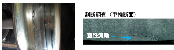
図6 車輪の踏面剥離
