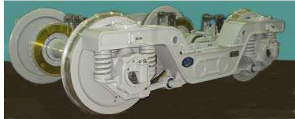
写真 1. PQ モニタリング台車。
