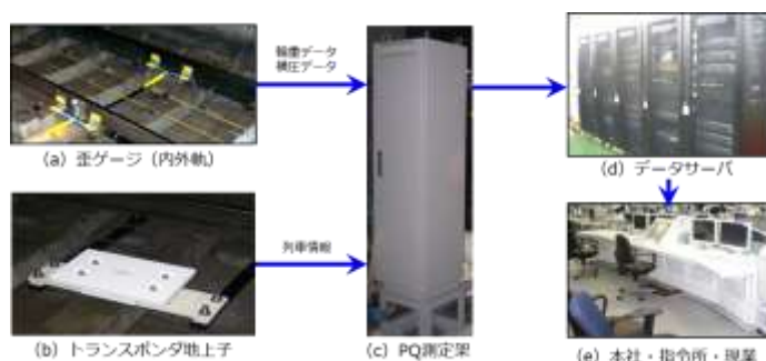
図 1. 状態監視装置システム構成
