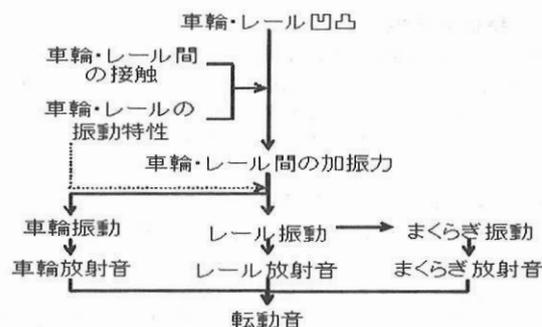
図1 転動音の発生メカニズム
