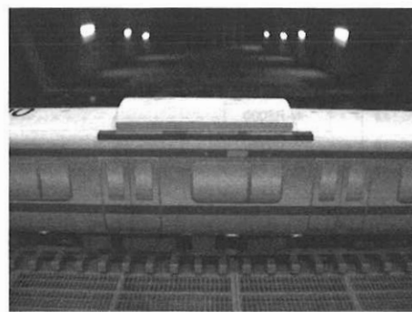
図 12 空調装置近傍のみ歩み板を設置した模型
