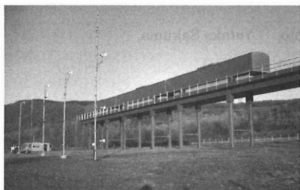
図 2 実物大車両模型 8)
