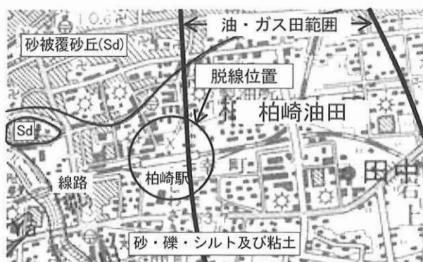
図-12 越後線柏崎駅付近の地質 13) と脱線の関係 12)
