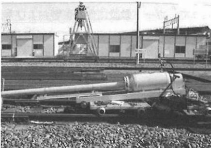
図 5 試験に使用した空気砲
