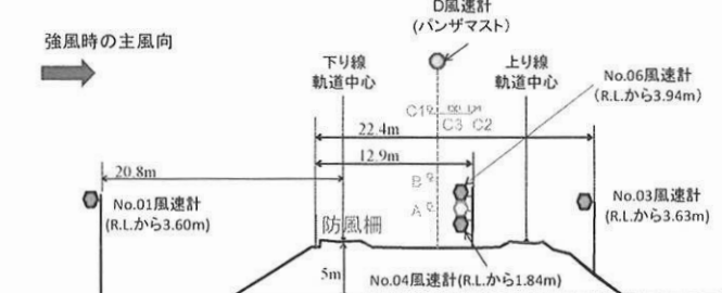
図 4 防風柵による風速の低減効果の比較検証に用いた風観測サイトの盛土断面と風速計配置
