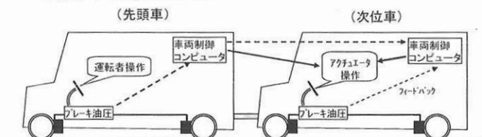
図 5 ブレーキ同調制御のブロック図
