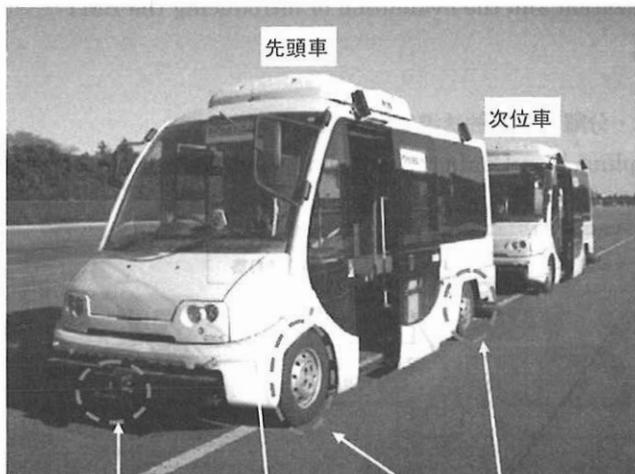
機械式連結器 車両制御コンピュータ 4輪自動操舵機構
