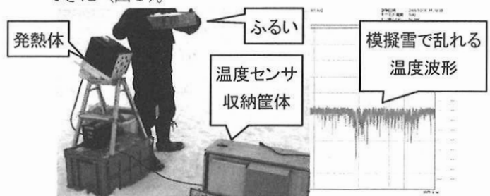
図 1 降雪模擬試験および測定した温度波形
