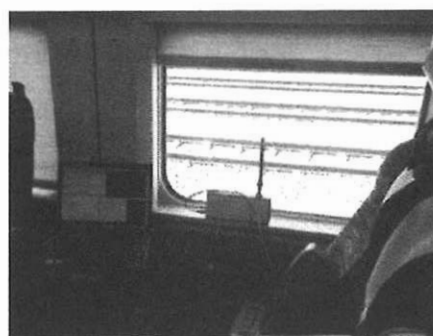
図 12 客室内への移動局装置仮設
