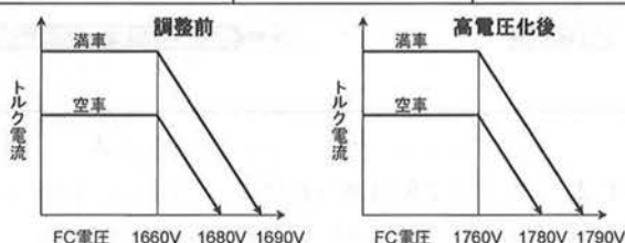
図6 架線電圧リミッタ特性
