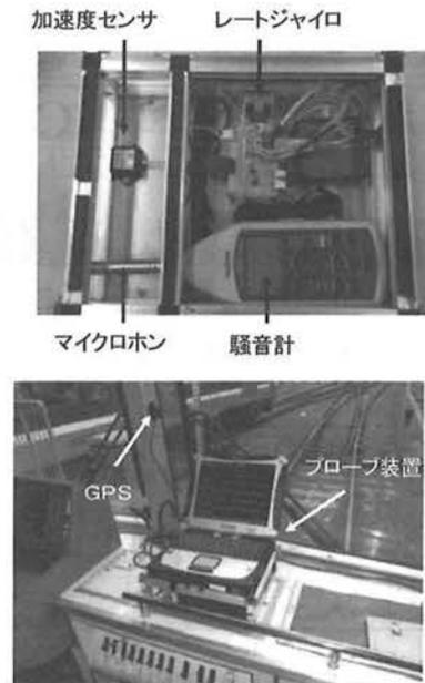
図 2 可搬型プローブシステム
