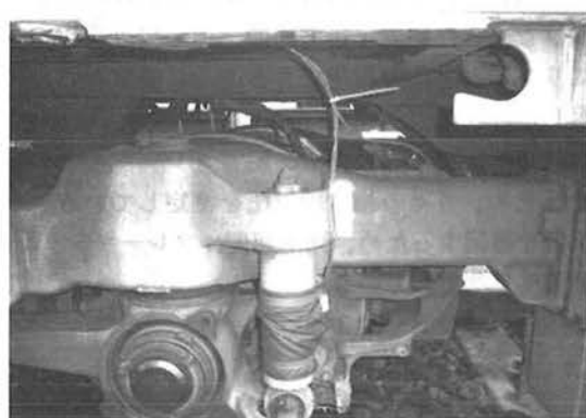
図 3-1 熱電対仮設状況
