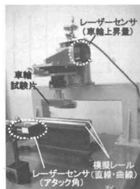
図1 車輪・レール接触位置測定装置
