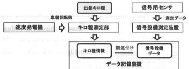
図 3 検測車の測定概要
