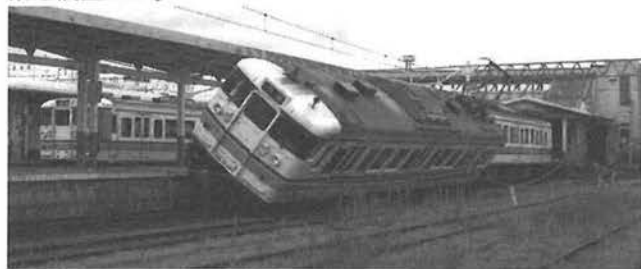
図1 中越沖地震により柏崎駅構内での脱線(文献(1)より)
