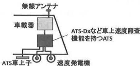
図 2 車上システムの基本構成
