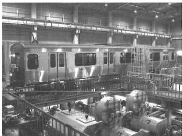
図1 振動試験車体と車両試験台
