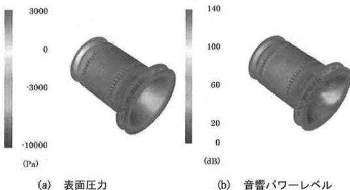
図 6 回転子周りの表面圧力と音響パワーレベル (6000min<sup>-1</sup>で5回転)
