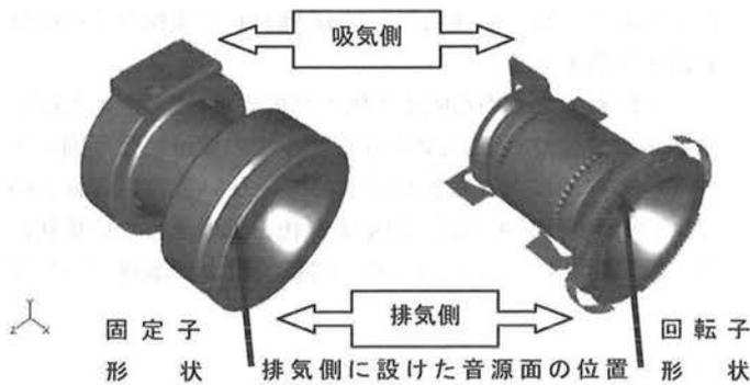
図4 主電動機モデルの外部と内部の形状と構成
